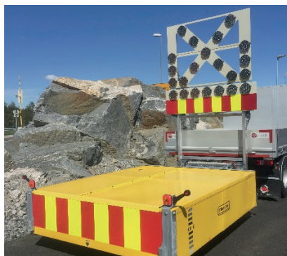
100K Julietta TMA bilmontert støtpute med varselpanel.
